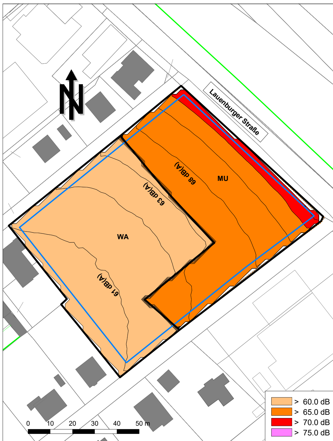
Abbildung 1: maßgeblicher Außenlärmpegel für schutzbedürftige Räume, Maßstab 1:500
