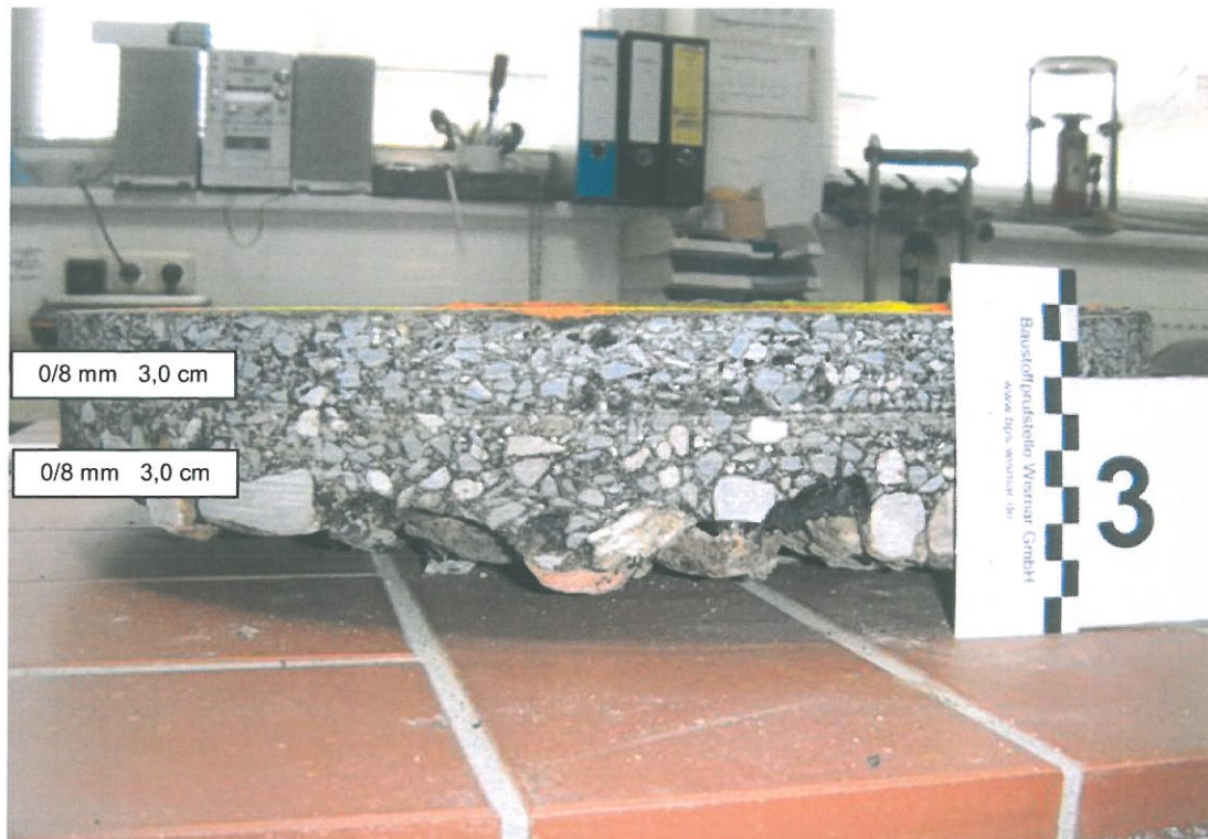
Bild 7: Bohrkern 3 Entnahmestelle: Schulweg km 0+559
