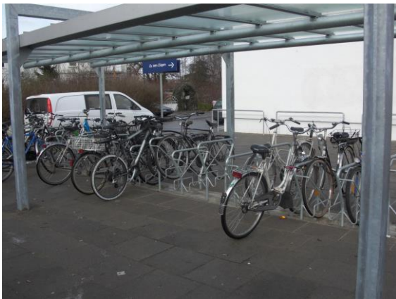
Abb. 7: Anlehnbügel, beidseitige Hoch-/Tiefeinsteller (Elsfleth)
