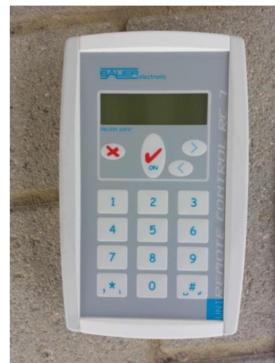
Abb. 13: Beispiel eines Programmiergeräts für den RFID-Zugang
